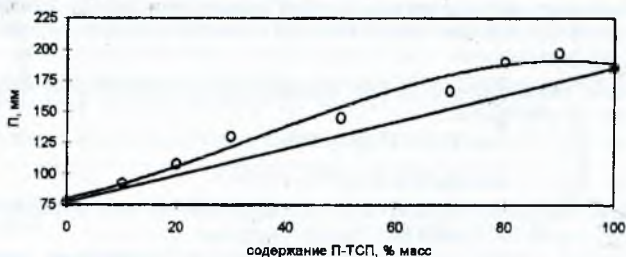
Рис.2. Влияние состава комплексной добавки на подвижность цементного теста
