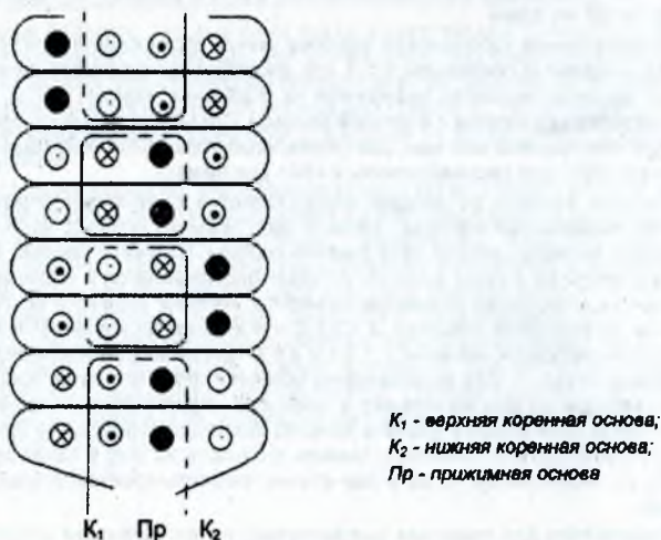
Рис. 2. Продольный разрез двухстороннего уточного гобелена
