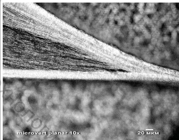
Рисунок 4 – Вид полученного образца нити в месте скрутки
