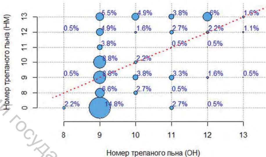
Рисунок 2 – Совместное распределение номеров длинного трепаного льноволокна определенных по новой методике (НМ) и согласно отраслевым нормам (ОН)
