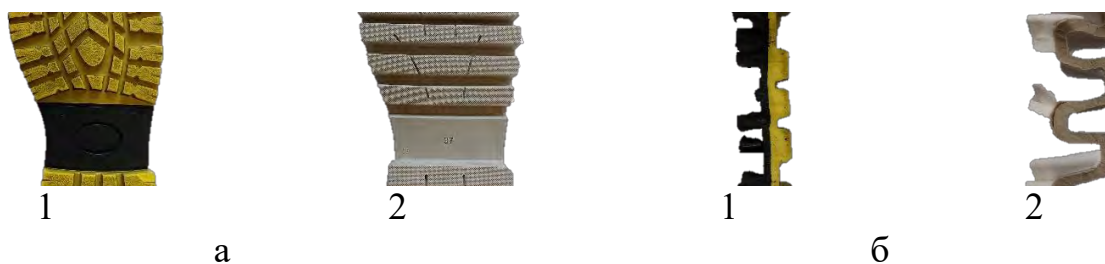
Рис. 2. Образцы современных подошв: а – вид ходовой поверхности, б – вид в разрезе
