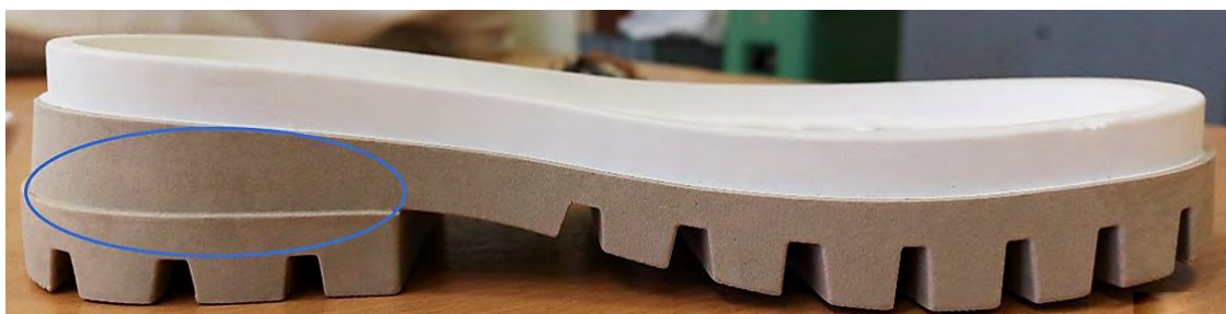
Рис. 4. Место вырубki образцов для испытания
