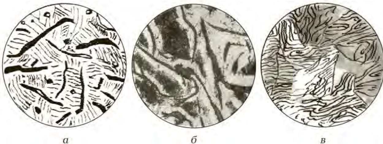
Рисунок 6.2 – Микроструктура серого чугуна: а – ферритный, б – ферритно-перлитный, в – перлитный
