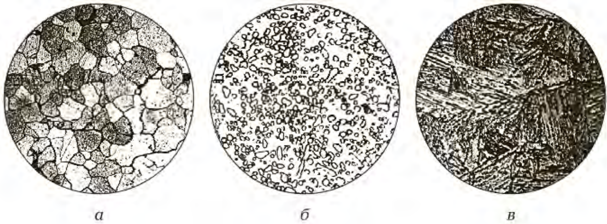
Рисунок 8.1 – Микроструктура закаленной стали: а – сорбит, б – троостит, в – мартенсита
