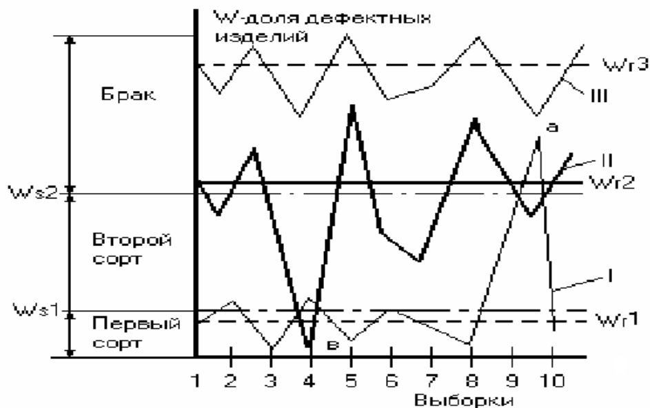
Рисунок 2.1 – Схема выявления ошибок первого и второго рода
