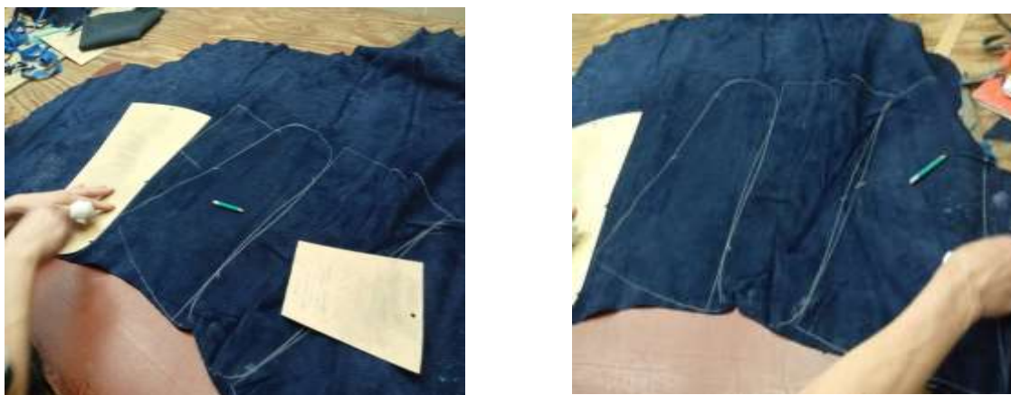
Рисунок 2. Раскладки лекал на спилке
