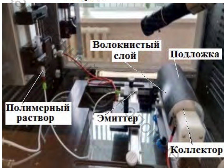
Рисунок 24 – Схема процесса электроформования на установке Fluidnatek LE-50
