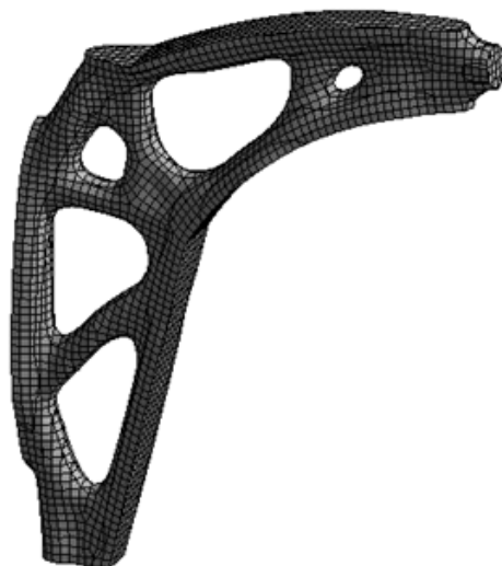
Рисунок 2 – Форма рычага, полученная в результате оптимизации
