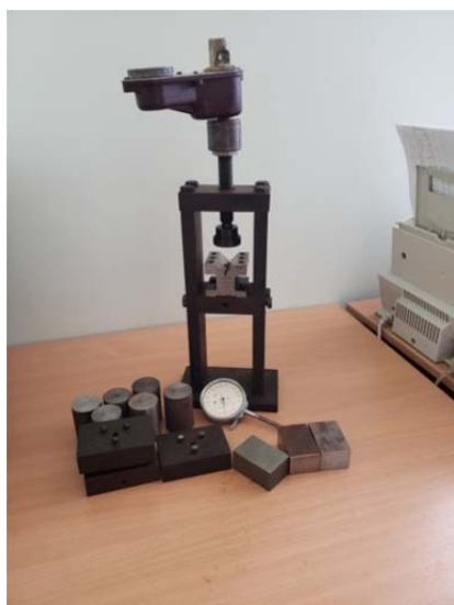
Рисунок 1 – Установка для определения погрешности закрепления заготовок
